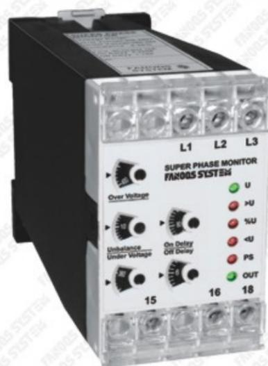
سوپرکنترل فازدستگاهی است که برای تشخیص خطاهای ولتاژشبکه سه فاز بکار میرود. ویژگی سوپرکنترل فاز فانوس سیستم بکارنبردن نول درتغذیه دستگاه وتنظیمات جداگانه برای حدود بالا وپایین ولتاژ ، عدم تساوی ولتاژشبکه سه فاز وهمچنین تنظیم برای زمان های تاخیردرقطع و تاخیردروصل میباشد.
