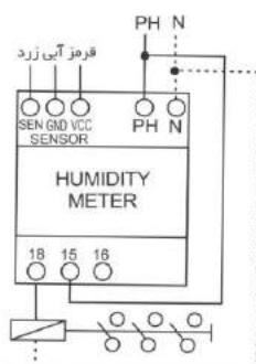
توجه: از وصل کردن مستقیم بارهای خازنی یا سوینچینگ یا درایورهای LED به دستگاه به دلیل جریان بیش از حد اراده اندازی در این نوع مصرف کننده ها، خودداری گردد. در این موارد الزاماً از رله خارجی یا کلکتاکتور مناسب استفاده گردد.
